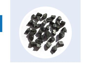
Крошка представляет собой дробленый до заданного размера твердый сплав, состав и свойства которого приведены в таблице:
