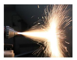
Повышение износостойкости рабочих поверхностей инструмента, деталей машин и механизмов, работающих в условиях интенсивного абразивного износа, является важнейшей задачей увеличения ресурса работы оборудования. Основными методами поверхностного упрочнения являются наплавка и напыление рабочих поверхностей износостойкими материалами.
